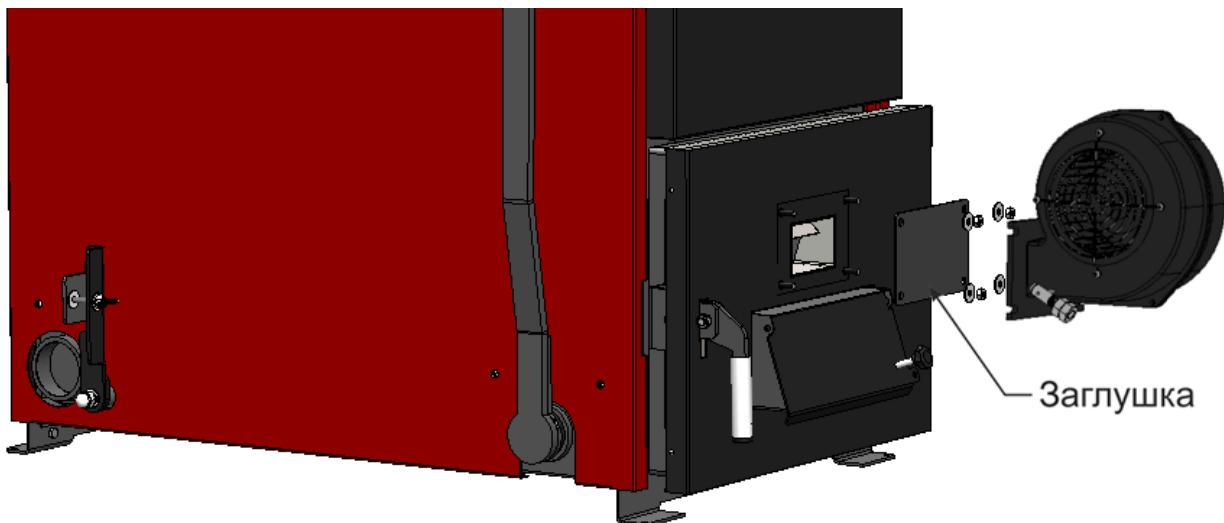
**Рис. 8 Снятие заглушки и установка вентилятора наддува**
