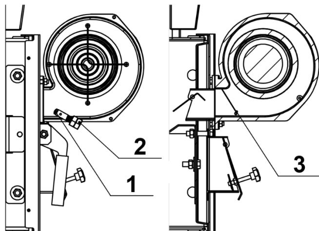
**Рис. 10 Установка заслонки вентилятора**
