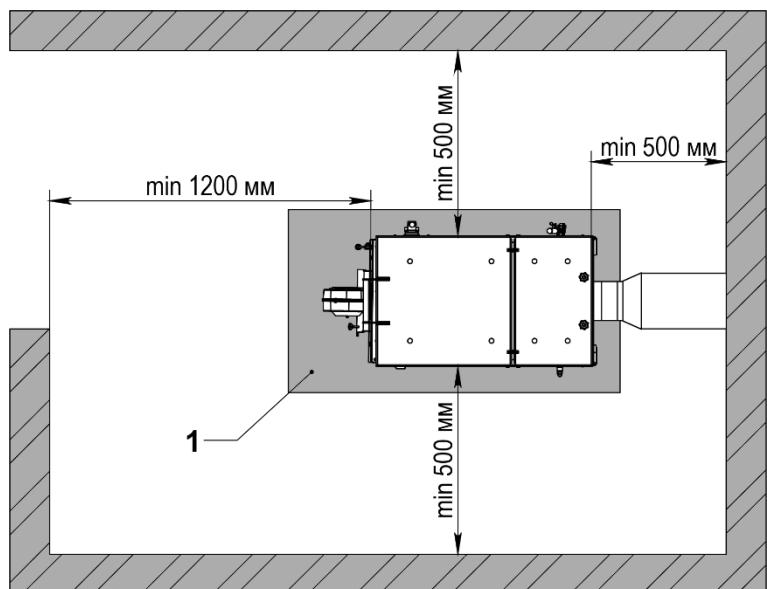
Фундамент (поз. 1 рис 3) должен быть больше основания котла. С передней стороны не менее чем на 300 мм, с других сторон примерно на 100 мм.
