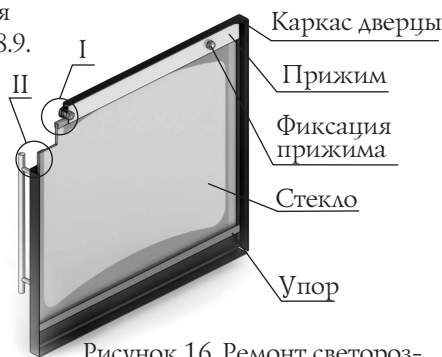
Рисунок 16. Ремонт светорозрачного экрана двери модели «Витра»
